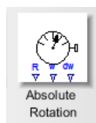
多体系统绝对转动测量元件
