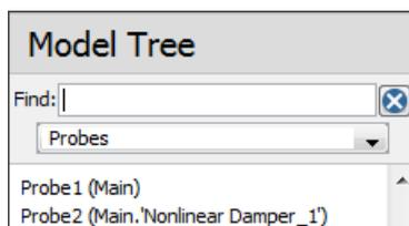
プローブがモデルのトップレベルに追加されている場合、プローブ名の横には括弧で **[Main]** と表示され、それ以外の場合は、プローブのサブシステム名がプローブ名の横に表示されます。上記例の場合、モデルには、モデルのトップレベルに **[Probe1]**、そして **[Main.Nonlinear Damper\_1]** という名前のサブシステム（つまり、**[Main]** にある **[Nonlinear Damper\_1]** サブシステム）に **[Probe2]** の2つのプローブが追加されています。
